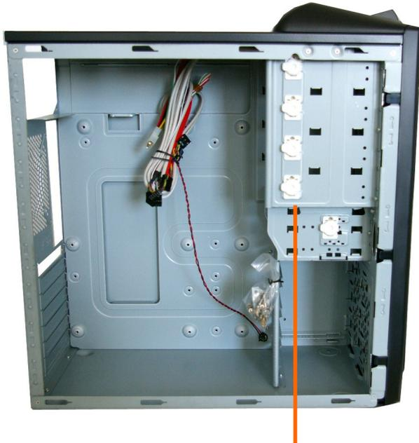
Schraubenlose Assemblierung von Laufwerken
