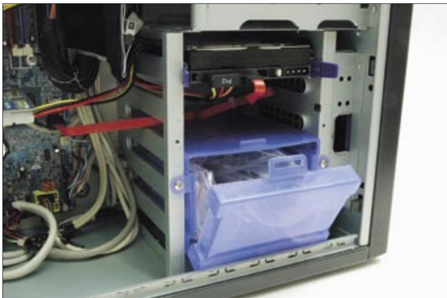
TCI-PCen monteres harddiskene sidelengs, noe som medfører både enklere montering og lettere tilgang til kabler.
